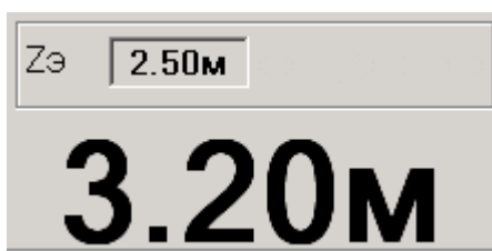
Рисунок 8.7 – Варианты отображения глубины (без и с поправкой за заглубление вибратора).
